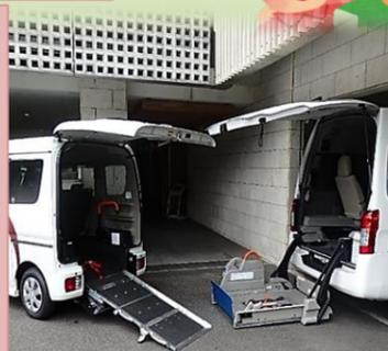
新しい車両がきました。軽自動車のフリージア号です。車椅子のフットレス付近をS字フックで引っ掛けボタンを押すと自動でスロープを上り車椅子が車に乗る事が出来ます。以前から使用しているSSキャラバン号は大きな車両でリクライニング車椅子をリフトで持ち上げて車に乗る事ができます。どのタイプの車椅子でも送迎が可能です
