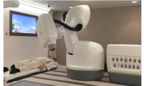
\*サイバーナイフ・・・ロボットアームを用いた次世代の定位放射線治療装置。3次的に放射線を当てる。さらに前処置で留置した金属マーカーを常時監視し、膀胱に溜まった尿等によって動く前立腺に合わせて放射線を当てる。
