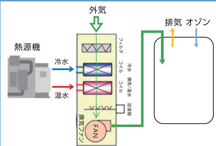
当院の主な空調システムをご紹介させて頂きます。熱源機にて夏は冷水、冬は温水を作り出し、院内各所の冷温水コイルへ循環させ、外気(新鮮な空気)を取り入れ、フィルターにてゴミ、塵、ウイルス等を除去し、各コイルにて設定温度へ冷やし、暖め、また、除湿、加湿し湿度調整を行なうことで快適な空調環境を提供しております。また空気浄化とし適切な換気回数をし、除菌、脱臭、感染予防のために、オゾン生成装置よりオゾンを院内へ供給しております。
